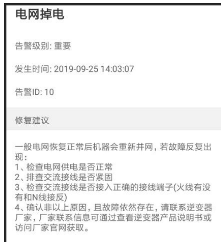
图 7-9 故障告警记录
